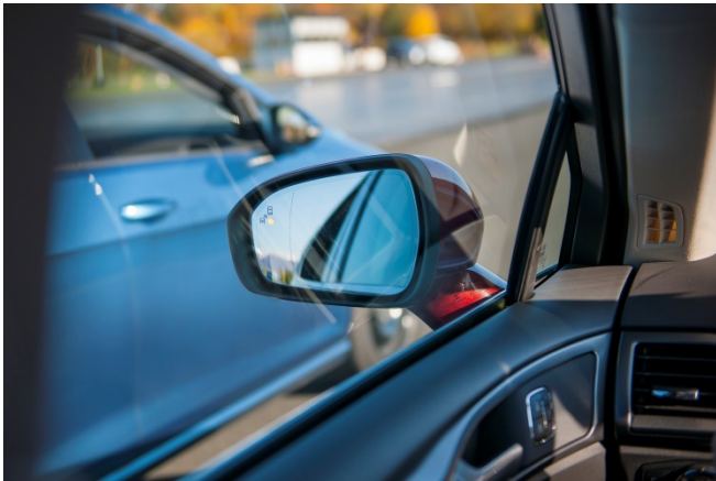
Abbildung: Der Spurwechselassistent warnt den Fahrer vor einem Fahrzeug auf der Nebenspur Bildnachweis: Deutscher Verkehrssicherheitsrat (DVR)
